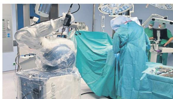
**So schaut der OP-Roboter aus:** Das Hightechgerät der US-Firma Stryker (links) – hier mit einer sterilen Folie abgedeckt – hat unter anderem einen Arbeitsarm (oben).
