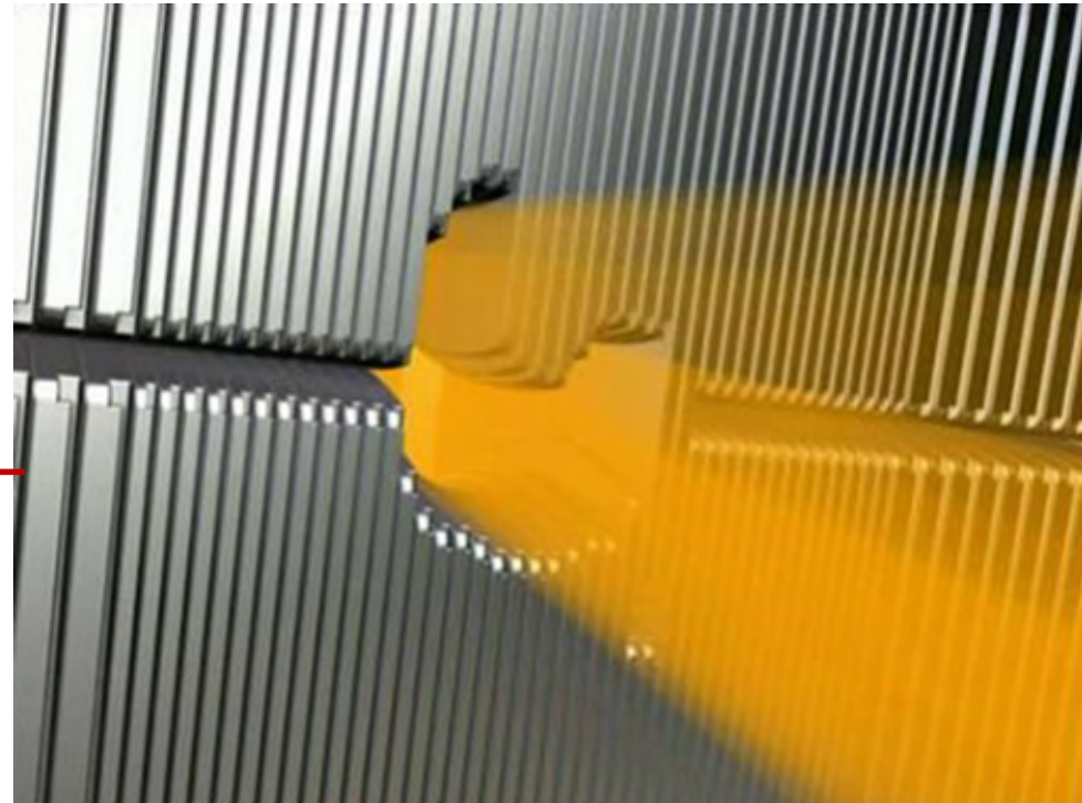
Während der Rotation des Strahlerkopf fahren dicke „Blei“-Lamellen in die Strahlöffnung und „filtern“ den Strahl
